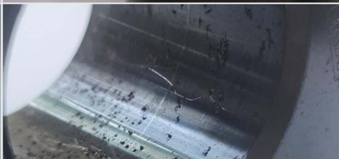
СТАНДАРТНЫЙ КОНУС №2 ОЧАГОВАЯ КОРРОЗИЯ
