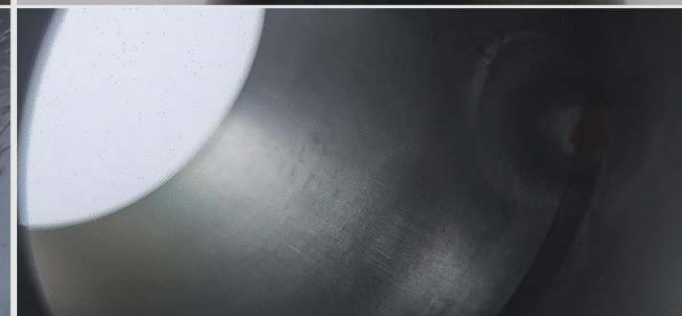
КОНУС SIVIK ARMOR №4 СЛЕДЫ КОРРОЗИИ ОТСУТСТВУЮТ
