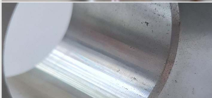
СТАНДАРТНЫЙ КОНУС №1 ТОЧЕЧНАЯ КОРРОЗИЯ
